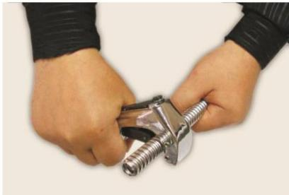
2. Помещаем отрезок трубы в вальцеватель
